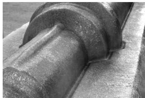
Abb. 36: Im Spritzgussverfahren bleibt die raue Oberfläche sichtbar Firma Faserplast Rickenbach-Wil: Rohrelement
