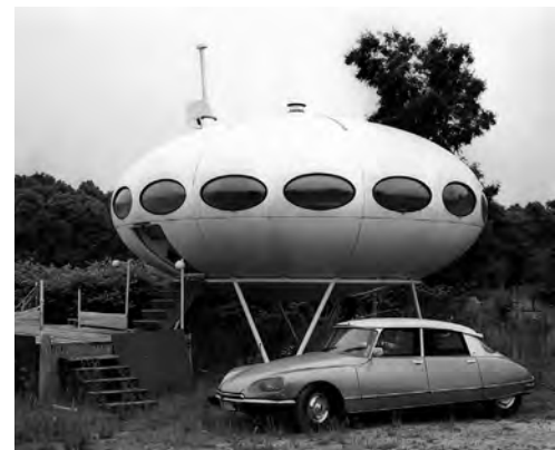
Abb. 34: Das weltweit erste in Serie gebaute Plastikhaus Matti Suuronen: Futuro Après-Ski Hütte, Finnland 1968
